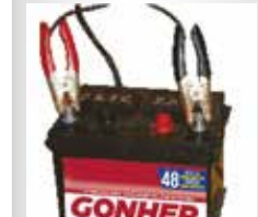
POLARIDAD INVERTIDA Recargar la batería con polaridad invertida e instalar de nuevo, causa daños al sistema eléctrico.
