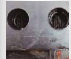
BAJO NIVEL DE ELECTROLITO Provocado por sobrecargas y/o aplicación incorrecta.
