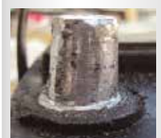
LIMADO Limar el poste para ocultar algún daño.
