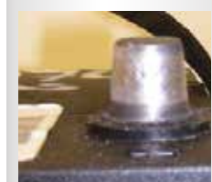
MODIFICADO Cuando se reconstruye un poste para ocultar algún daño.
