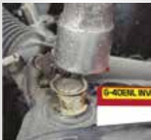
GOLPEAR LA TERMINAL Cerciórese de abrir bien las terminales al colocarlas en los postes, evite golpes con cualquier otro objeto.
