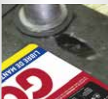
PERFORADA Causada por mala sujeción o al golpear con algún objeto.
