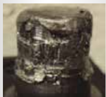
APRETADO Por utilizar terminales inadecuadas o usar terminal negativa en poste positivo.
