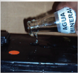
AÑADIR LÍQUIDOS EXTRAÑOS No introduzca líquidos extraños y/o electrolito de dudosa procedencia.
